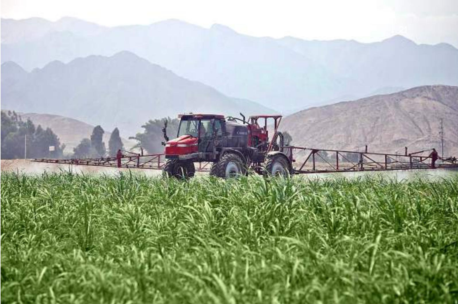
APLICACIÓN DE HERBICIDAS CON EL NUEVO EQUIPO PULVERIZADOR AUTOPROPULSADO CASE.
