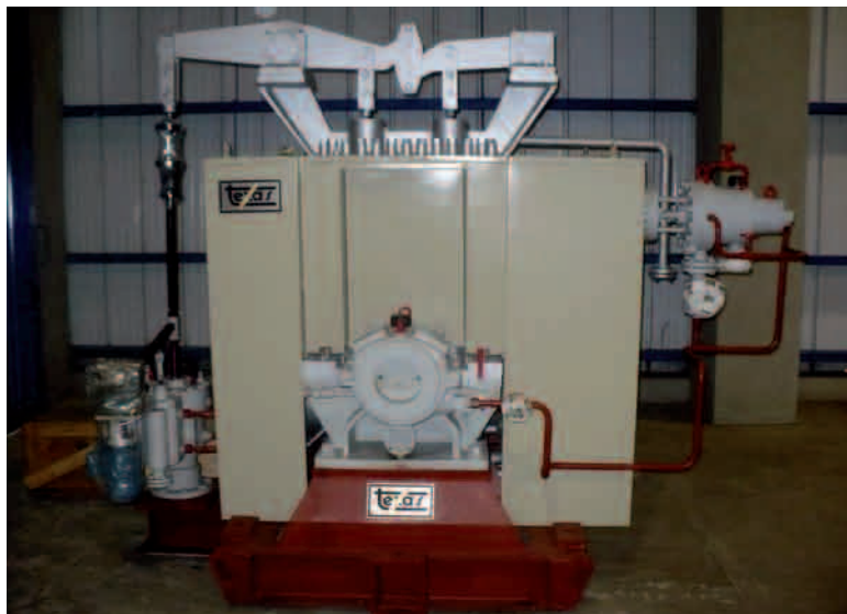
Turbina Texas para el Desfibrador Fives Cail.
