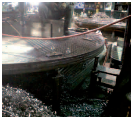
Perforación de placas de los Reboilers
