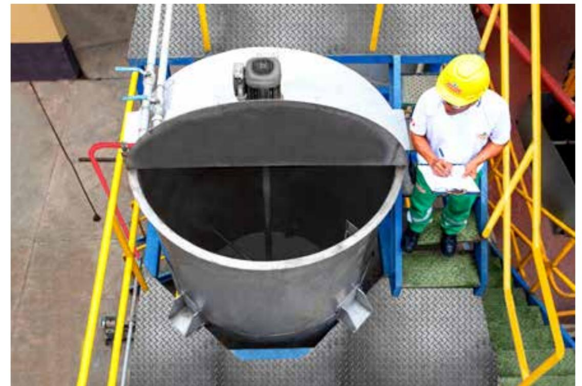
Arriba: Medición de vibraciones mecánicas de motor para efectos de análisis y diagnóstico de condición del equipo (motor). Abajo: Nuevo sistema de preparación del floculante.
